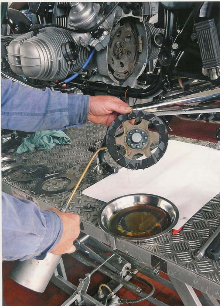
Härtest: Die spezielle Trockenkupplung von Siebenrock wird absichtlich eingebißt. Und tatsächlich: Sie funktioniert auch „nass“
